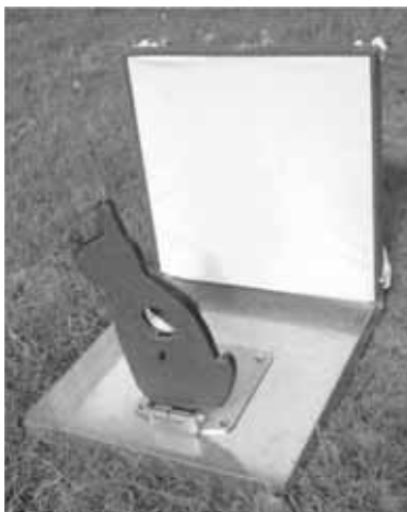
Abbildung 6.4.6.2 Seitenansicht eines Field-Target-Geschossfanges
